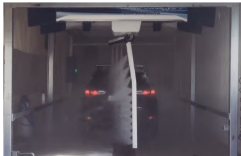
Этап смывки водой
